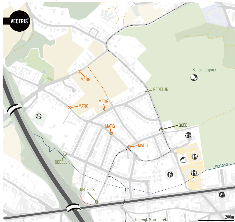
Figuur 20: Resultaten infiltratieproeven
