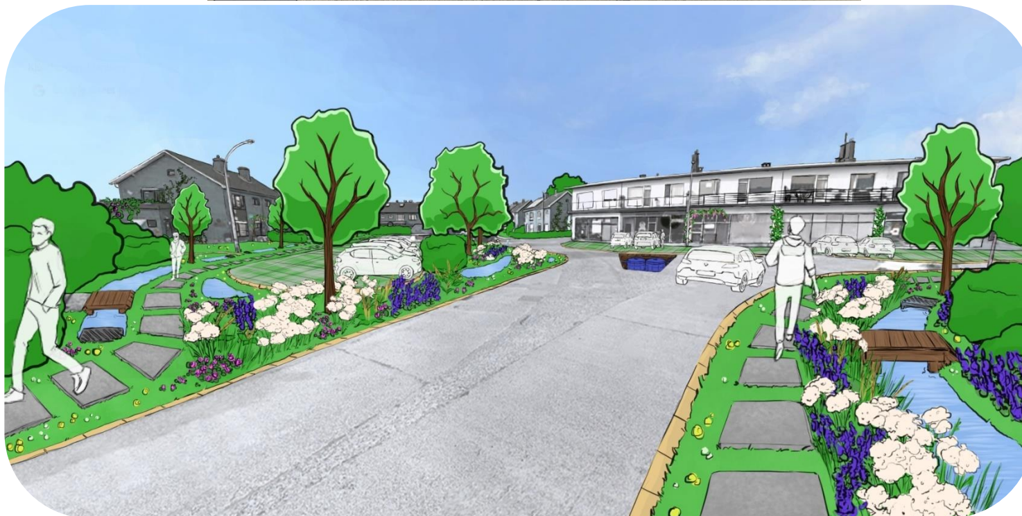
Figuur 1: Bestaande toestand (bovenaan) en toekomstvisie (onderaan) t.h.v. de H. Dom. Saviolaan. De toekomstvisie omvat maatregelen zoals ontharding, wadi's, verlaagde groenzones, boomschaduw, ondergrondse hemelwaterputten, etc.
