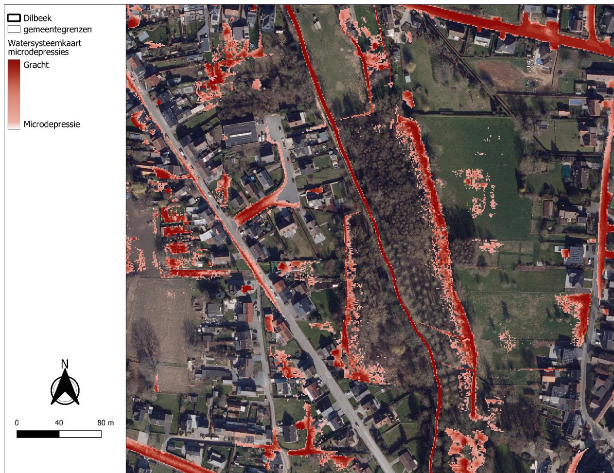
Figuur 81: Identificatie van geschikte locaties voor infiltratie/buffering in Sint-Martens-Bodegem (microdepressies) (locatie bossen rondom de Zierbeek aan de Molenstraat en de Wijmenier) (Universiteit Antwerpen, 2022).
